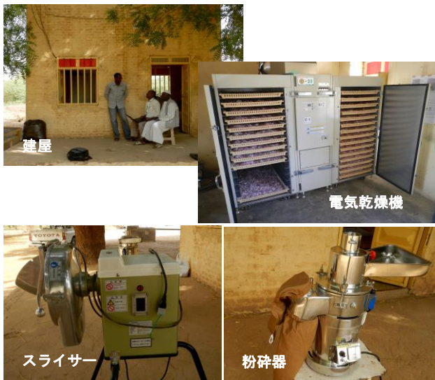
乾燥機を設置した家屋と設置機材
