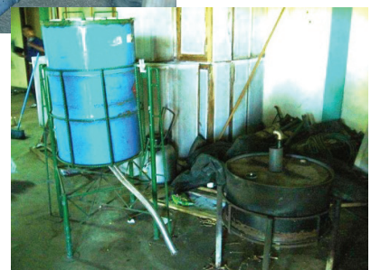
土壌消毒機(右)は左の青い缶に土壌を入れ、右手前の黒い缶で湯を沸かし蒸気をパイプで送る。UNAN の 3 名の創意工夫には目を見張る。
