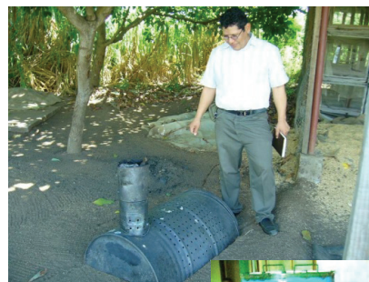
土壌消毒機(右)は左の青い缶に土壌を入れ、右手前の黒い缶で湯を沸かし蒸気をパイプで送る。UNAN の 3 名の創意工夫には目を見張る。
