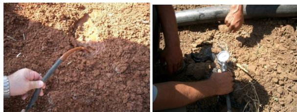
流量測定については、一つのエミッターから例えば5分間に流れ出す水の量を測定し、1 時間当たりの流量に換算する。メスシリンダーでの直接計量を異なった場所で繰り返してもいいが、人手がある場合にはペットボトルの先を切ったものや洗面器等を利用して、数カ所で同時に計量した方が効率的に均一性をチェックできる。プロジェクトではそれぞれ容器を持った小学生が圃場内の9ヶ所に立ち、「よーいドン」から「ストップ」の掛け声で5分間採水し、一人がメスシリンダーを持って計量して回るという方法も採用したが、なかなか好評だった。
