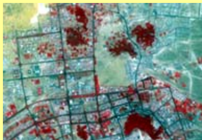
フォールスカラー画像 森林・農地は赤系統、市街地は青系統
