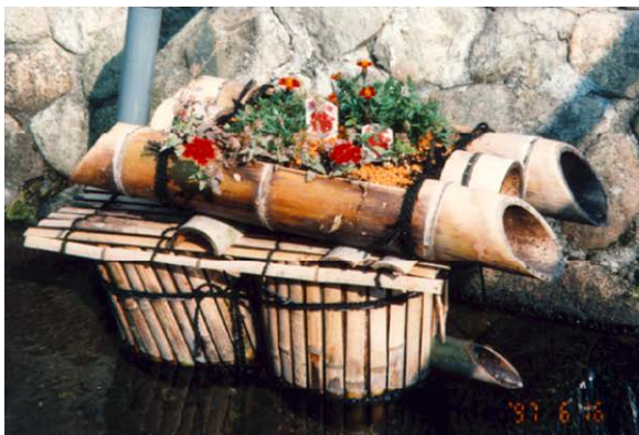
家庭排水簡易浄化装置(甲良町)
