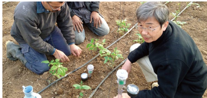
テンシオメータを使った節水灌漑試験のデモ圃場 (2013年) A demonstration plot for water saving irrigation using tensiometers (2013)
