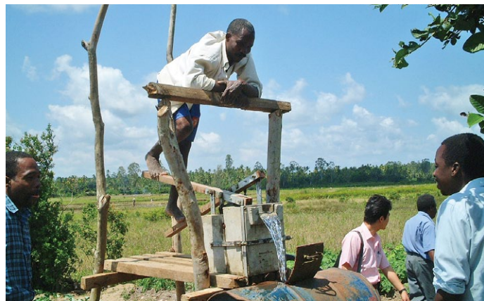
ザンジバル島に導入されていた足踏みポンプの性能試験(2003年) Testing the performance of the foot operated pump that was introduced in Zanzibar (2003)
