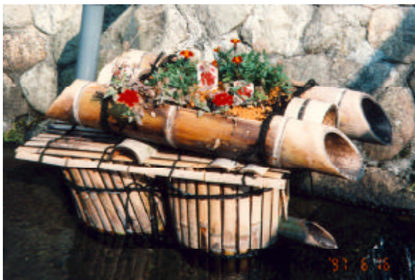
家庭排水簡易浄化装置 (甲良町)
